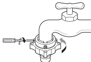
**4** Tire la placa de cierre del conector hacia abajo, presione la manguera de entrada contra el adaptador y suelte la placa de cierre del conector. Asegúrese de que el adaptador se trabe.
