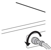
**2** 用小钳子拆下进水过滤器，然后使用中等硬度牙刷清理过滤器。
