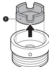
3 将接头往上推至水龙头末端，从而使橡胶密封圈形成紧密连接。拧紧4个固定螺丝和接头环板。
