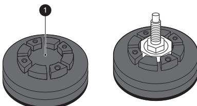
· 为了减少振动，我们建议在本电器的每个调整支脚下放置至少 20 mm 厚的橡胶皮碗 1，并使用螺丝将其固定在至少两根地板梁上。
