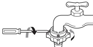
4 下拉接头插销板⑥，将进水管推到接头上，并松开接头插销板。请确保将接头锁定到位。
