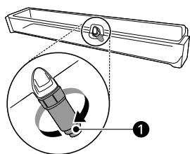
**5** قم بتنظيف خزان المياه وصمام الماء تحت المياه الجاري. ثم امسح الجزء الداخلي والخارجي لخزان المياه وباب الثلاجة بقطعة قماش نظيف.
