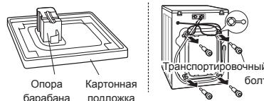
Снимите транспортировочные болты и опоры.
