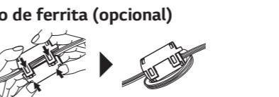
Enrolle el cable de alimentación alrededor del núcleo de ferrita dos veces.
