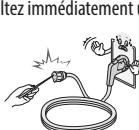
N'insérez pas de conducteur (comme une baguette métallique) dans l'une des extrémités du câble d'alimentation si l'autre extrémité est reliée au terminal d'entrée mural. En outre, ne touchez pas le câble d'alimentation juste après le raccordement au terminal d'entrée mural. Vous pourriez vous électrocuter.
