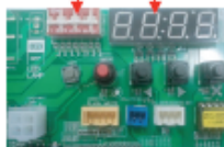
Circuit imprimé de l'unité extérieure
