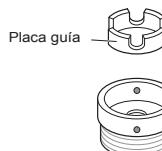
3 Empuje el adaptador sobre el extremo del grifo para que la junta de goma forme una conexión estanca. Apriete los cuatro tornillos de fijación.
