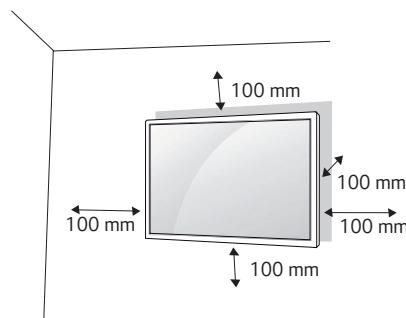
Para instalar su monitor en una pared, coloque un soporte de pared (componente opcional) en la parte posterior del monitor.
