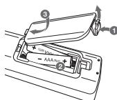
Retire la cubierta de las baterías que está en la parte posterior del control remoto e introduzca la batería de forma que **+** y **-** coincidan.
