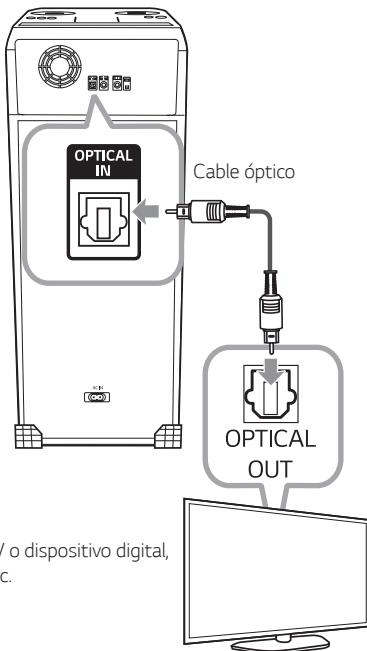
2. Pulse **F** hasta seleccionar la función OPTICAL.
