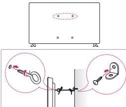
1 Insérez et serrez les boulons à œil, ou les supports et les boulons à l'arrière de la TV.
