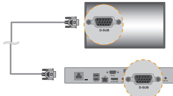
**3** Подключите MP700 к монитору с помощью кабеля LINE-OUT.
