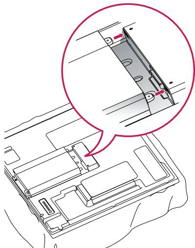
2 Закрепите MP700 на устройстве с помощью четырех прилагаемых винтов.
