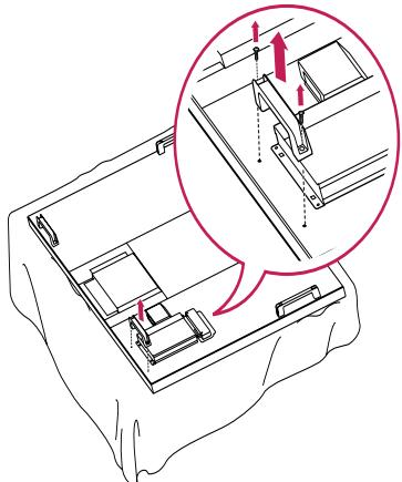
2 Вставьте медиапроигрыватель в отсек на задней панели устройства для его установки.
