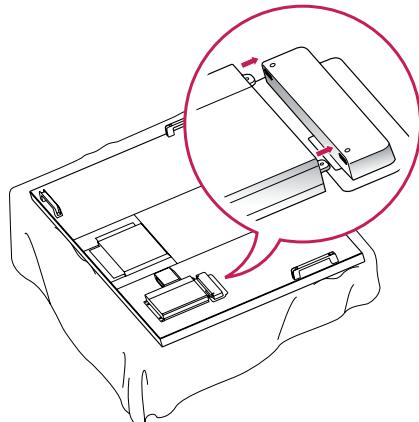
3 Закрепите медиапроигрыватель на устройстве с помощью четырех прилагаемых винтов.
