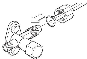
3 最后，使用扭矩扳手紧固扩口螺母，直到扳手发出咔哒声。
