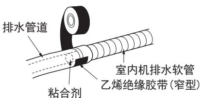
在连接部位缠绕绝缘材料。
