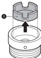
3 将接头往上推至水龙头末端，从而使橡胶密封圈形成紧密连接。拧紧 4 个固定螺丝和接头环板。
