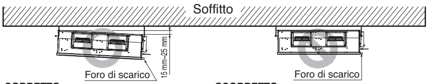
Condotto nascosto nel soffitto - Statica alta
