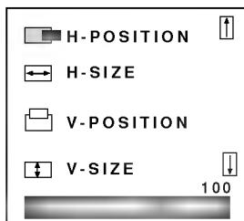
La gráfica de barra muestra el nivel actual del control "H-Position" seleccionado. Utilice el botón de control de ajuste para incrementar o disminuir el nivel para fijar la imagen al tamaño deseado. Cuando termine, oprima el botón de entrada "Enter" una sola vez para regresar al Menú Principal 1 para seleccionar otra opción. Si ha terminado de usar el OSD después de haber regresado al Menú Principal 1, puede oprimir el botón de entrada "Enter" dos veces para salir de OSD.
