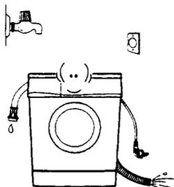
2 拔出排水塞，将机内的水排除。
