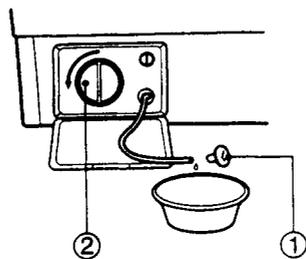
3 清除排水泵滤网中的杂质。清洁完,顺时针转动排水泵滤网,将排水塞插回原处。关上下盖。
