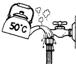
2 将拆下的进水管浸泡于约 50°C 的热水中。
