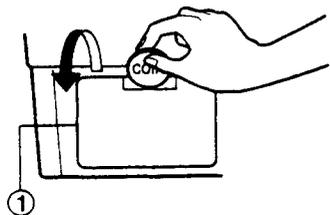
2 取下排水塞(①),让水流出来,当再没有水流出来时,向左转动排水泵滤网(②),直到将其打开。
