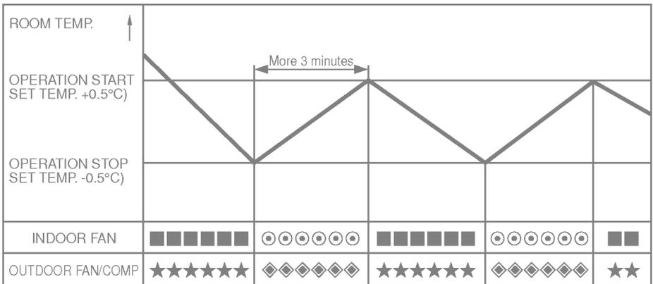
■ : SETTING FAN SPEED    ⊙ : LOW COOL OPERATION    ★ : COMP ON    ◆ : COMP OFF
