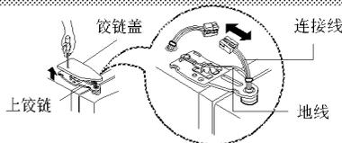
2) 按逆时针方向(①)旋转，拆掉固定器，然后向上(②)抬起，取出上铰链。
