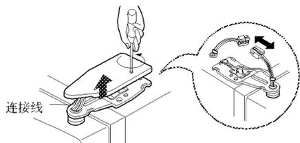
2) 按顺时针方向(①)旋转，拆掉固定器，然后向上(②)抬起，取出上铰链。
