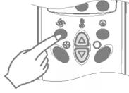
لإلغاء وضعية التبريد السريع ، اضغط على زر التبريد السريع مرة اخرى ، او زر سرعة المروحة في وضعية التبريد.
