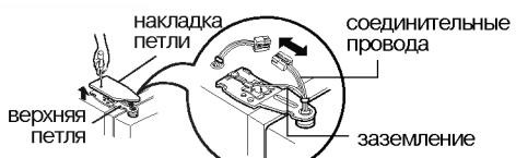
2) Снимите держатель, поворачивая его по часовой стрелке (①), а затем поднимите верхнюю петлю (②).
