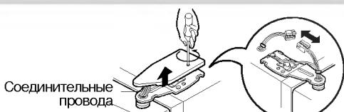
2) Снимите держатель, поворачивая его по часовой стрелке (①), а затем поднимите верхнюю петлю (②).
