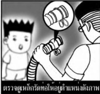
ต่อข้อต่อของท่อระบายน้ำทิ้งเข้ากับเครื่อง
