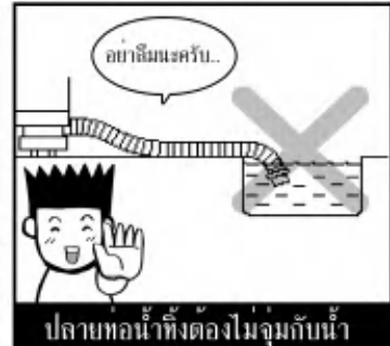
ท่อระบายน้ำทิ้งควรมีความยาวไม่เกิน 2 เมตร สูงจากพื้นไม่เกิน 4 ซม.
