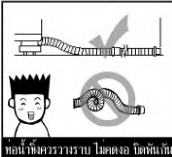
ท่อระบายน้ำทิ้งควรมีความยาวไม่เกิน 2 เมตร สูงจากพื้นไม่เกิน 4 ซม.
