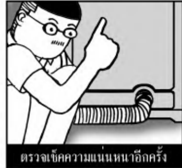
ต่อข้อต่อของท่อระบายน้ำทิ้งเข้ากับเครื่อง
