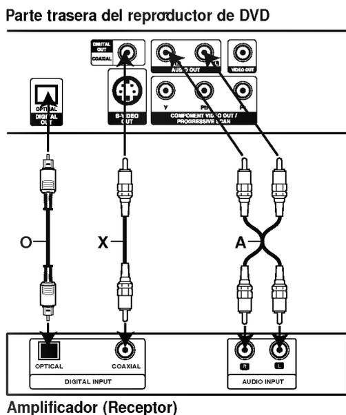
**Amplificador equipado con 2 canales de sonido estéreo análogo o Dolby Pro Logic II / Pro Logic:** Conecte las tomas de SALIDA DE AUDIO derecha e izquierda del reproductor de DVD a las tomas de ENTRADA izquierda y derecha de su amplificador, receptor o sistema estéreo, utilizando los cables de audio (A).
