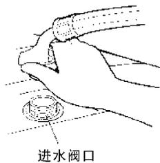
顺时针缓慢旋紧进水管连接座，以确保进水管连接座与进水管连接牢固。
