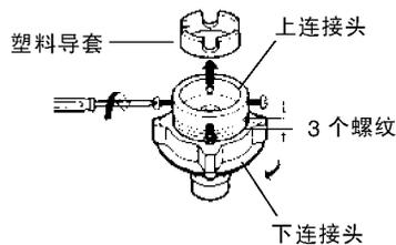
调整连接头的四个螺钉，使靠墙壁侧的两个螺钉首先与水龙头外侧充分接触。
