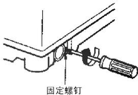
盖上后盖，上螺钉。将排水孔帽安装到底座另一侧面。
