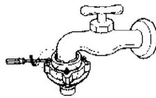
旋转下连接头直到上下连接头拧紧为止(如未紧,会发生漏水)。旋转后,上下连接头之间的间隙在3mm以下。
