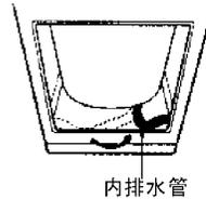
将内排水管安装到位后，**必须**上紧固定排水管的螺钉。
