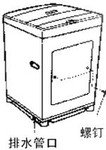
小心地将内排水管移至另一方向，勿将它折损。
