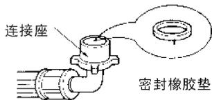
将进水管连接座竖直安放在进水管口上。
