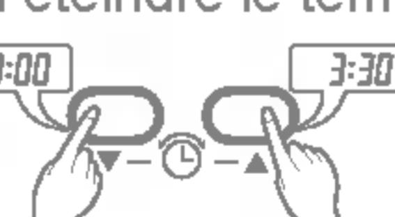
5. Afin de régler le temps sélectionné, appuyez sur la touche Timer SET (réglage de la minuterie).
