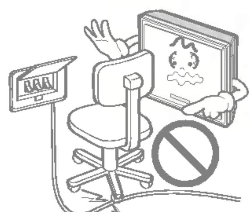
N'allumez ni n'éteignez le climatiseur en branchant ou débranchant la fiche d'alimentation.
