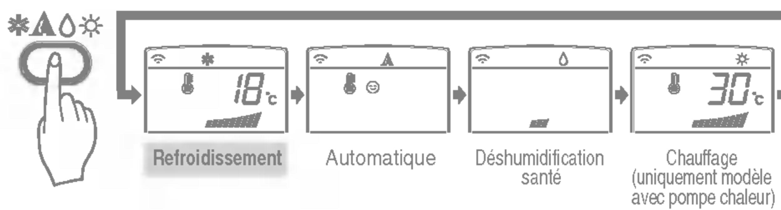
3 Fermez la télécommande. Introduire une température plus basse que celle de la pièce. La température peut être réglée avec une excursion de 18°C à 30°C avec des augmentations de 1°C.
