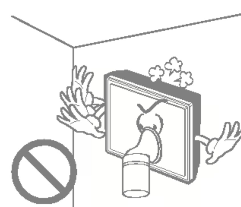
**S'il y a une fuite de gaz inflammable, fermez le robinet à gaz et ouvrez une fenêtre pour ventiler la pièce avant de mettre en marche le climatiseur. N'utilisez le téléphone ni ne déplacez les interrupteurs sur les positions marche (on) ou arrêt (off).**
