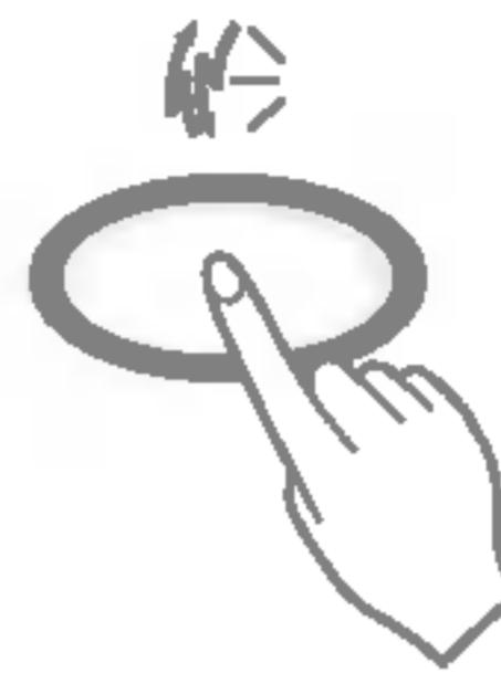
Appuyez à nouveau sur le bouton et les lames d'aération s'arrêtent. Après 30 minutes, les lames d'aération se remettent automatiquement en position d'aération maximale.
