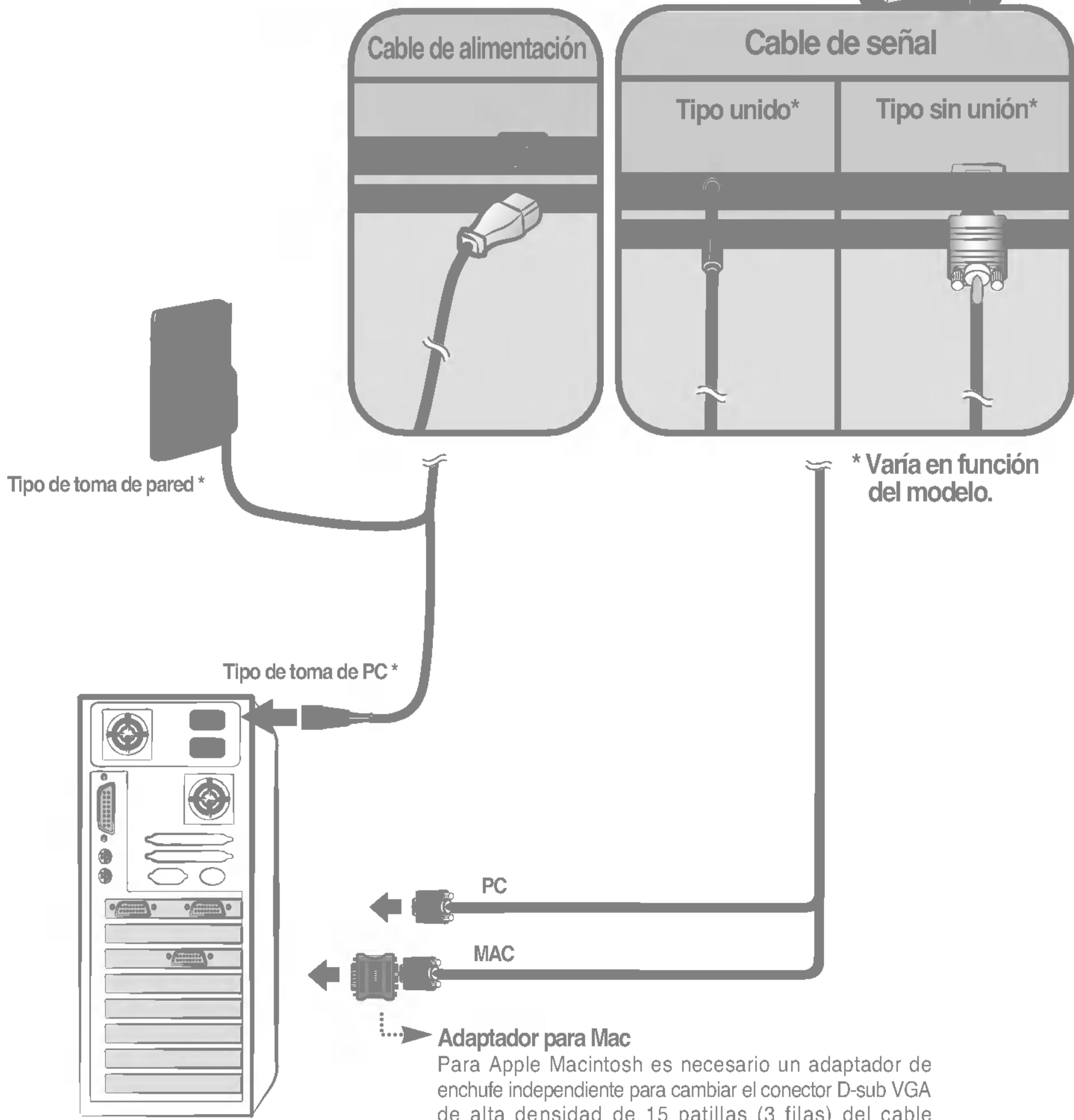
Para Apple Macintosh es necesario un adaptador de enchufe independiente para cambiar el conector D-sub VGA de alta densidad de 15 patillas (3 filas) del cable suministrado por un conector de 15 patillas y 2 filas.
