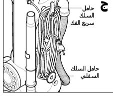
أمسك سلك التيار الكهربي بمشبك حول سلك التيار الكهربي. (الشكل. د)
