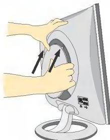
3. Cuando estén conectados los cables, vuelva a colocar la cubierta posterior en la ranura de la sección superior y fije la estructura empujando hacia arriba.
