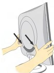
4. Inserte la cubierta posterior en las ranuras inferiores situadas a ambos lados sujetando la parte inferior.
