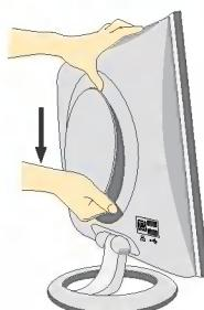
1. Separe la cubierta posterior deslizando la sección inferior hacia abajo, tal y como se muestra en la figura.
