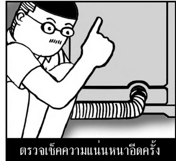
ต่อข้องอของท่อน้ำ ดันเข้ากับเครื่อง
