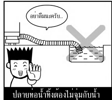
ต้องน้อยกว่า 4 cm ต้องน้อยกว่า 2 เมตร หากมีการต่อท่อเพิ่ม ความยาวสาย ท่อน้ำทิ้งต้องยาวรวมไม่เกิน 8 ม. ไม่ควรยาวเกิน 2 ม. สูงจากพื้นไม่เกิน 4 ซม.
