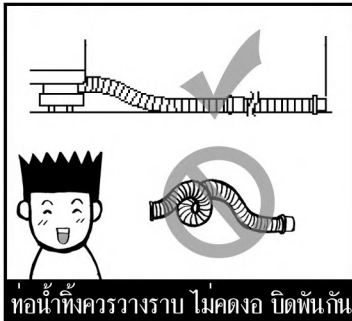
ต้องน้อยกว่า 4 cm ต้องน้อยกว่า 2 เมตร หากมีการต่อท่อเพิ่ม ความยาวสาย ท่อน้ำทิ้งต้องยาวรวมไม่เกิน 8 ม. ไม่ควรยาวเกิน 2 ม. สูงจากพื้นไม่เกิน 4 ซม.
