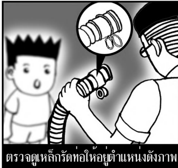
ต่อข้องอของท่อน้ำ ดันเข้ากับเครื่อง
