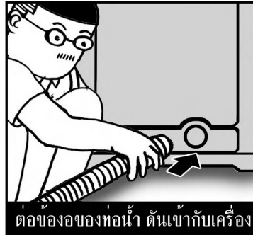
ตรวจสอบให้รัดท่อให้อยู่ตำแหน่งดังภาพ
