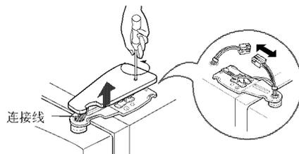
2) 按顺时针方向 ① 旋转，拆掉固定器，然后向上 ② 抬起，取出上铰链。
