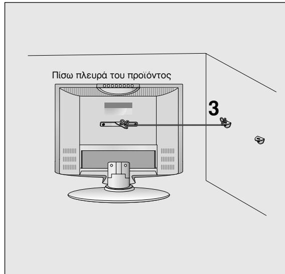
1. Χρησιμοποιήστε το υποστήριγμα και τη βίδα για να στερεώσετε το προϊόν στον τοίχο, όπως φαίνεται στην εικόνα.
