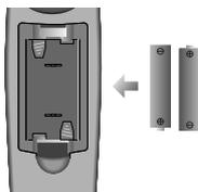
**Примечание:** Во избежание повреждений ПДУ вследствие вытекания электролита из батареек извлеките батарейки из ПДУ, если вы не намерены пользоваться ПДУ в течение длительного времени.
