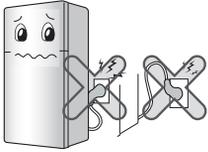
قد يُسكب الماء أو قد يتلف القياس مما يتسبب في نشوب حريق أو صعق كهربائي.
