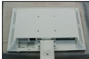
2. Séparez le socle à l'aide d'un tournevis comme montré dans le schéma.
