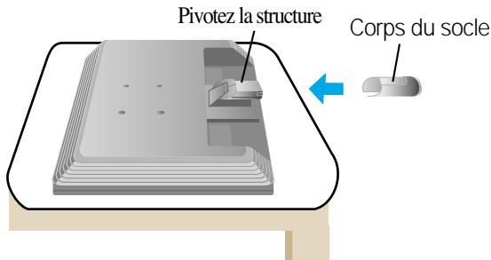
3. Insérez la Base du socle dans le Corps du socle dans la direction indiquée ci-dessous. Cependant, le corps du socle ne sera correctement fixé que lorsqu'il sera connecté à sa base.
