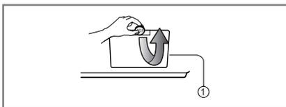
1. Откройте дверцу на нижней панели (1) при помощи монетки. Поверните дренажную пробку (2), чтобы освободить дренажный шланг.
