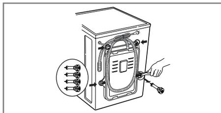
1. Для предотвращения повреждения внутренних деталей машины при транспортировке в машине закреплены 4 транспортировочных болта. Перед началом эксплуатации машины эти болты необходимо удалить вместе с резиновыми заглушками.
