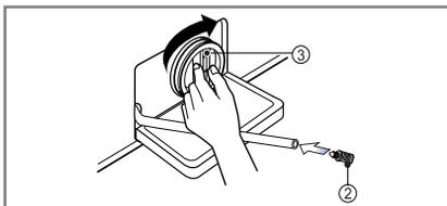
4. После чистки поверните фильтр (3) по часовой стрелке и вставьте на место дренажную пробку (2). Закройте дверцу на нижней панели.
