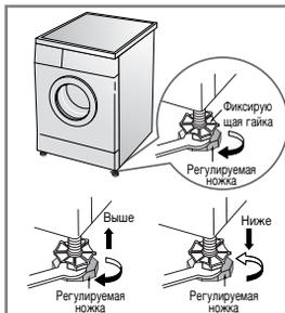
2. Если пол неровный, обеспечьте горизонтальное положение стиральной машины при помощи регулируемой ножки. (Не следует для выравнивания положения подкладывать под ножки куски древесины и т.п.) Убедитесь, что все четыре ножки твердо стоят на полу, а затем проверьте горизонтальное положение стиральной машины (при помощи спиртового уровня).
