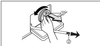
2. Выньте дренажную пробку (2), чтобы остатки воды стекли. Подставьте какой-нибудь сосуд, чтобы вода не попала на пол. Когда вода перестанет течь, откройте фильтр дренажного насоса (3), повернув его против часовой стрелки.
