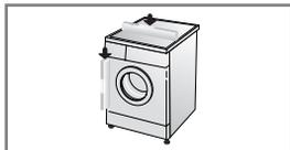
1. Для предотвращения вибрации и чрезмерного шума необходимо придать стиральной машине строго горизонтальное положение. Стиральную машину следует устанавливать на твердом, ровном полу, желательно в углу комнаты.
