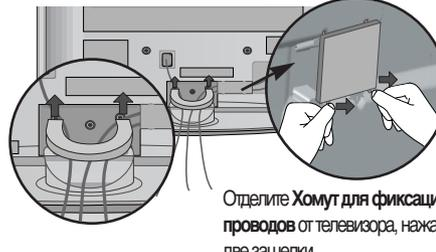
Отделите **Хомут для фиксации проводов** от телевизора, нажав на две защелки.
