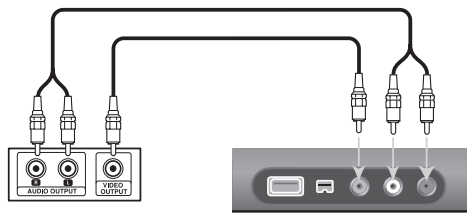
Panel de tomas de equipo adicional (VCR, videocámara, etc.)
