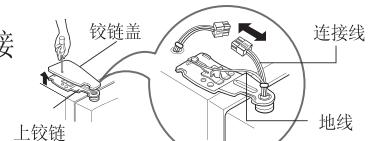
2 ) 以逆时针方向(①)旋转，拆掉固定器，然后向上(②)抬起，取出上铰链。
