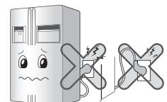
切勿让电源线弯曲、扭曲或被重物挤压，以免损坏。
