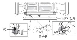
하단 덮개와 급수관을 순차적으로 제거합니다. 위로 들어올려서 하단 덮개를 제거한 다음 그리고 클립⑩을 제거한 후 오른쪽 그림에서와 같이 (①)부위를 누르면서 급수관을 당겨 올립니다.
