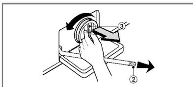
2. Выньте дренажную пробку (②), чтобы остатки воды стекли. Подставьте какой-нибудь сосуд, чтобы вода не попала на пол. Когда вода перестанет течь, откройте фильтр дренажного насоса (③), повернув его против часовой стрелки.
