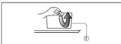
1. Откройте дверцу на нижней панели (①) при помощи монетки. Поверните дренажную пробку (②), чтобы освободить дренажный шланг.
