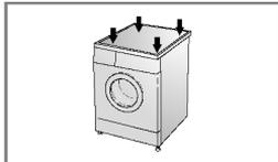
1. Для предотвращения вибрации и чрезмерного шума необходимо придать стиральной машине строго горизонтальное положение. Стиральную машину следует устанавливать на твердом, ровном полу, желательно в углу комнаты.
