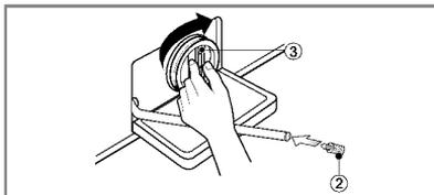
4. После чистки поверните фильтр (③) по часовой стрелке и вставьте на место дренажную пробку (②). Закройте дверцу на нижней панели.
