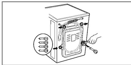
1. Для предотвращения повреждения внутренних деталей машины при транспортировке в машине закреплены 4 транспортировочных болта. Перед началом эксплуатации машины эти болты необходимо удалить вместе с резиновыми заглушками.
