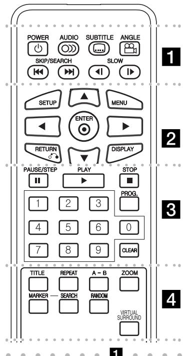
**POWER** (⊕): permet d'allumer ou d'éteindre l'appareil.
