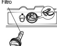
**4** Vuelva a colocar la tapa. Inserte el filtro a lo largo de las canaletas guía dentro de la cubierta de la bomba. El filtro debe mirar hacia las canaletas guía dentro de la cubierta de la bomba. Luego gire fuertemente la tapa de la bomba en el sentido de las manecillas del reloj.
