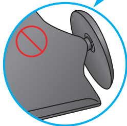
正しく取り付けできていない状態
