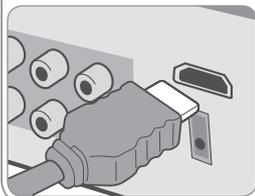
使用 HDMI 电缆连接此机器上的 HDMI OUT PORT（高清输出）插孔到兼容 HDMI 的电视机。
