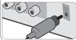
连接此机器的光纤输入插孔到 TV（或数码设备等）的光输出插孔。
