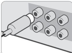
使用视频电缆连接本机的 VIDEO OUTPUT（显示屏）插孔和电视机上相应的输入插孔。
