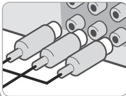
使用绿蓝红线将本机的 COMPONENT VIDEO (PROGRESSIVE SCAN) OUTPUT（分量视屏输出）插孔与电视机上相应的输入插孔进行连接。
