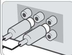
本机音频具有色码插孔（红色代表右音频，白色代表左音频）。如果电视只有一个音频输入（单声道），将其连到本机左端（白色）的音频插孔。
