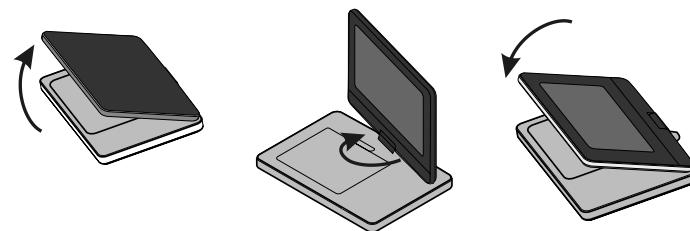
لتدوير الشاشة، ضع الوحدة على سطح ثابت ومستوى مثل المنضدة. اضغط على لوحة العرض ثم ارفعها في وضع رأسى. أور الشاشة باتجاه عقارب الساعة ببطء 180 درجة، إذا أردت ذلك، فقم بطي لوحة الشاشة بعد تدويرها.
