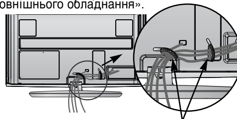
Кріплення для кабелів
