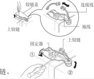
2) 以逆时针方向(①)旋转,拆掉固定器,然后向上(②)抬起,取出上铰链。
