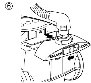
جهت برداشتن آدیتور دمنده از اهرمی که در آن تعجبی شده است استفاده فرمائید.
