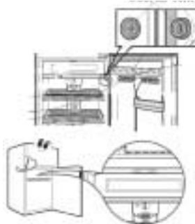
Orifice de ventilation réfrigérante
