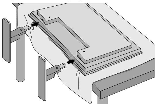
3. Utilisez les vis pour fixer le pied sur la face arrière du produit, comme indiqué dans le diagramme.
