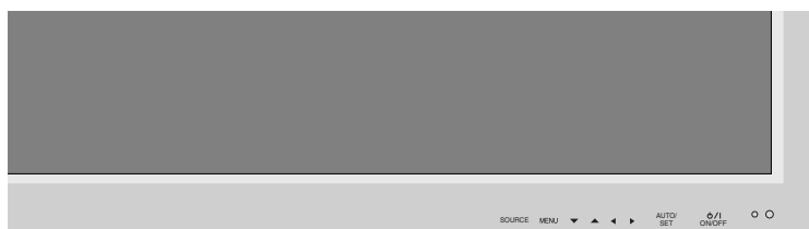
TOUCHE DE MISE SOUS/HORS TENSION
